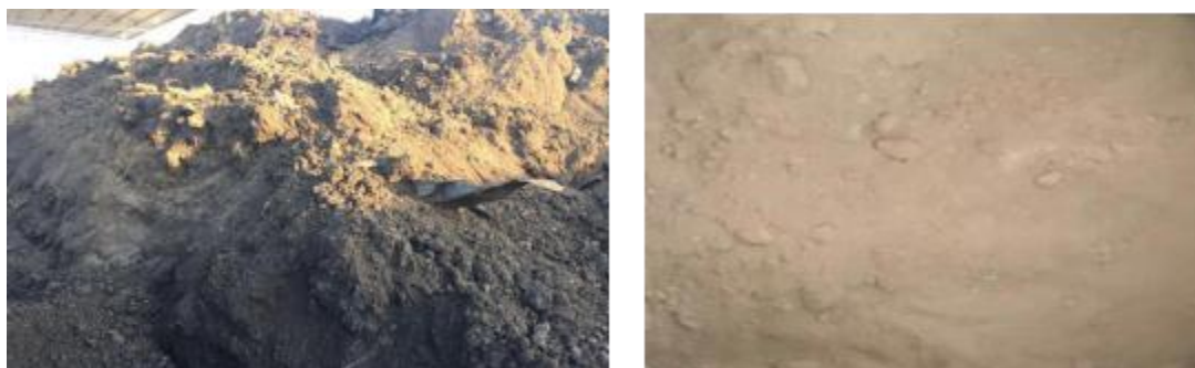
图 3.4-3 油泥砂和含油污泥热解处理前后对比图
