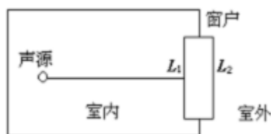
图 7.5-1 室内声源向室外传播示意图
